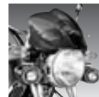
Nebelscheinwerfer Die Elpisoptik sorgt für eine gute Lichtausbeute; hochglanzverchromte, stabile Aluminiumhalterung. (Bei R 1200 C Independent Serienausstattung.)
